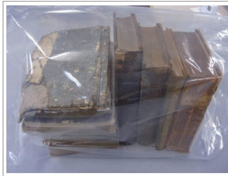
一般的な文化財害虫を100%致死させるのに必要な処理時間 温度 25.5°C/湿度55%RH 袋内酸素濃度 0.1% (酸素検知剤エージレスアイの色 (袋内が酸素濃度0.1%であることを示す))
