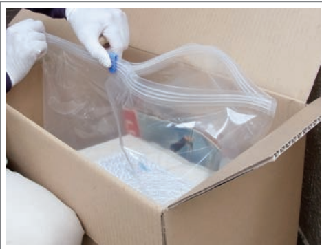
一般的な文化財害虫を100%致死させるのに必要な処理時間 温度 25.5°C/湿度55%RH 袋内酸素濃度 0.1% (酸素検知剤エージレスアイの色 (袋内が酸素濃度0.1%であることを示す))
