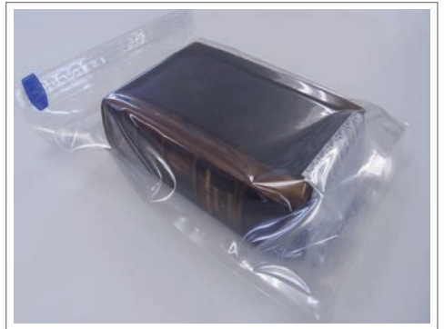
一般的な文化財害虫を100%致死させるのに必要な処理時間 温度 25.5°C/湿度55%RH 袋内酸素濃度 0.1% (酸素検知剤エージレスアイの色 (袋内が酸素濃度0.1%であることを示す))
