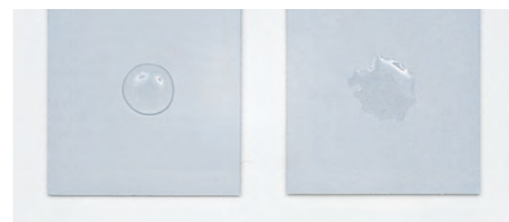
▲比較実験結果。不活性フィルムをコートしたもの(左)、従来のもの(右)、それぞれ水滴を落として20分間放置。
