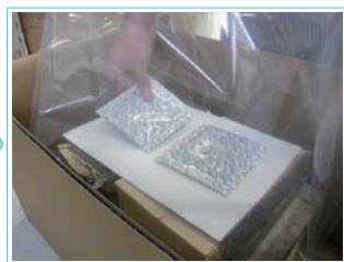
2. エージレスセットを開封し、袋内部に入れる。エージレスアイが外から確認できるようにする。
