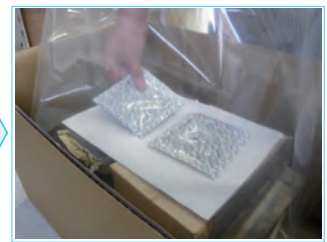
2. エージレスセットを開封し、袋内部に入れる。エージレスアイが外から確認できるようにする。
